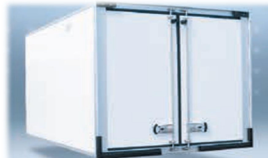
Композитні панелі (харчовий гелеобразний шар - поліефір - поліуретан), оснащені алюмінієвими вставками
